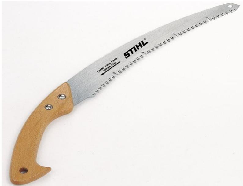
Fabriqué en acier au carbone trempé, pour un sciage très rapide avec des surfaces de coupe lisses. Dent de groupe avec fentes de dégagement, poignée à crochet en bois de hêtre. Longueur de la lame de scie 32 cm.
