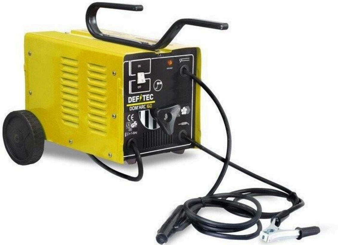
Mobile avec 2 roues et poignée supérieure, ventilé pour un usage prolongé, réglage de l'intensité, protection thermostatique contre les surcharges. Puissance absorbée 8kW, facteur de marche 10% à 160A. Intensité de soudage 55 à 160A.
