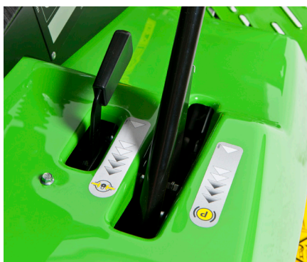
Avance hydrostatique avec blocage de différentiel
